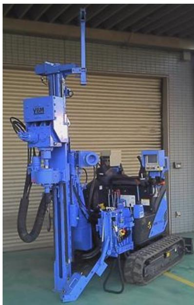
写真 2-1 掘削機(YBM 社製)
